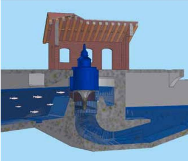
Abb. 1: schematische Darstellung der Turbinengeometrie und der Fischpassage
